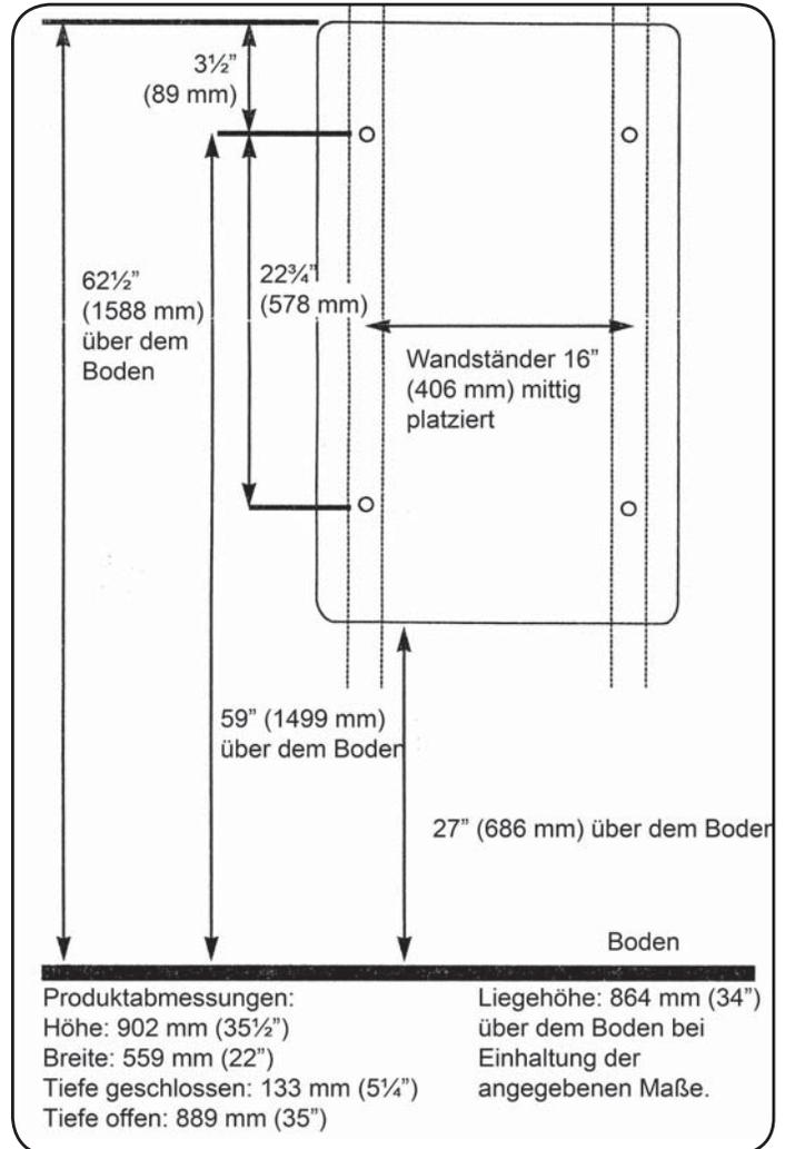
Besitzt die Wand Holzständer, deren Abstand zueinander nicht 16 Zoll (41 cm) beträgt, oder Metallständer oder ist sie aus Beton, bohren Sie mit einem 1/2"-(12 mm)-Mauerbohrer. (Vor der Montage müssen Sie sich ggf. Knebel besorgen.) Planen Sie je nach Art der Knebel einen Mindestplatz hinter der Mauer ein, damit sich diese drehen können. Setzen Sie die Knebel ein und ziehen Sie sie fest.
