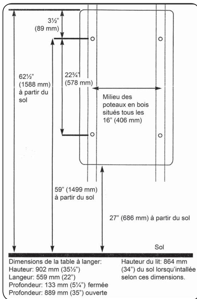
Si les murs ont des poteaux en bois qui ne sont pas situés tous les 16 po (40,6 cm), s'ils ont des poteaux métalliques ou s'ils présentent une couche de ciment sous-jacente, utilisez une mèche pour maçonnerie de 1/2 po (12 mm) pour percer. Il faut parfois acheter des boulons à ailettes avant l'installation. Selon le type de boulons à ailettes utilisé, prévoyez un espace minimum dans le mur pour pouvoir tourner les boulons à ailettes. Insérez et serrez les boulons à ailettes.
